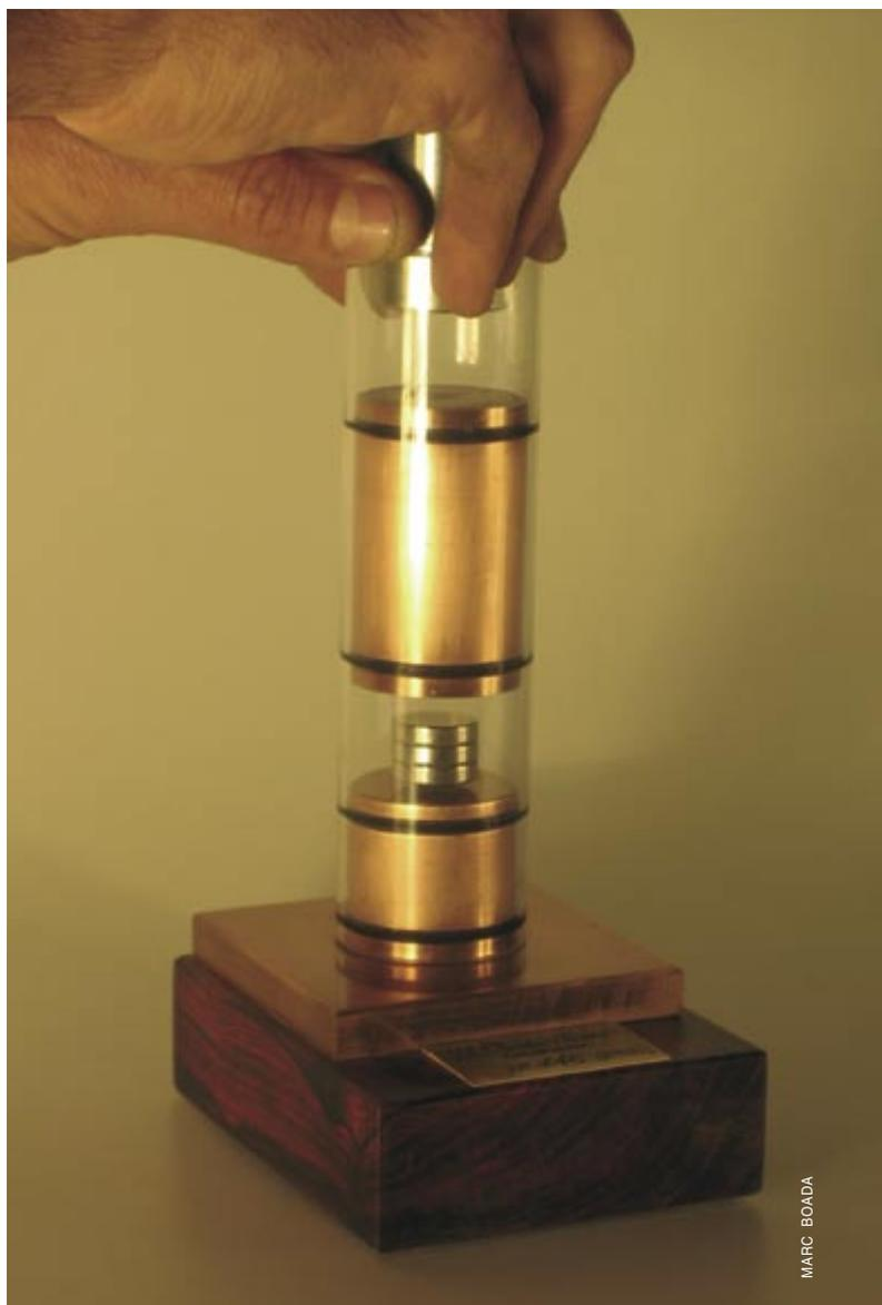
Levitador magnético construido con dos imanes de neodimio y frenos magnéticos de cobre.
