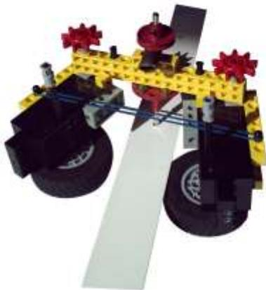
Bei einem System befand sich auf der linken und der rechten Seite ein durch jeweils einen Legomotor betriebenes Reibrad, welches durch ein Haushaltsgummi an den Wagen gedrückt wurde.
