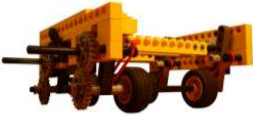
Wir konstruierten ein neues System, bei dem sich die Reibräder aus Platzgründen über dem Wagen befanden. Die Oberseite der Wagen bot in der Mitte keine Angriffsfläche. Um den Druck dennoch gleichmäßig zu verteilen, brachten wir über der Schiene gefederte Achsen an, an denen je links und rechts ein Reibrad befestigt war.
